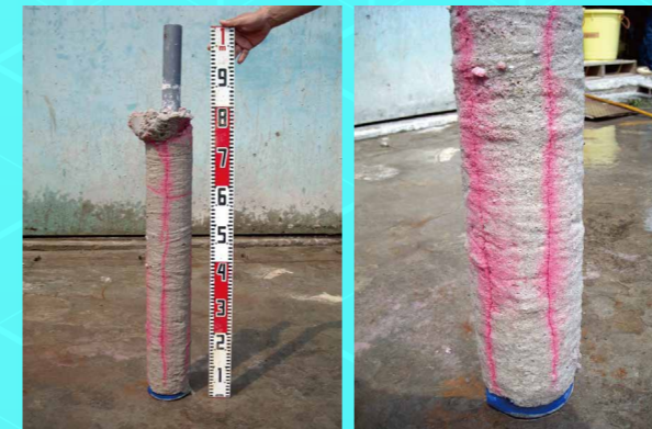
ポリゴンパイプ クラッキング試験(クラック発生状況)
